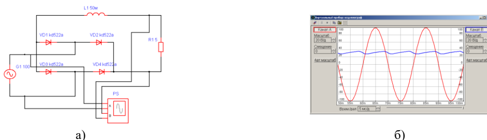
Рисунок 2. Моделирование процесса выпрямления переменного напряжения в программе ASIMEC: а) создание схемы выпрямителя, б) результаты работы виртуального осциллографа
