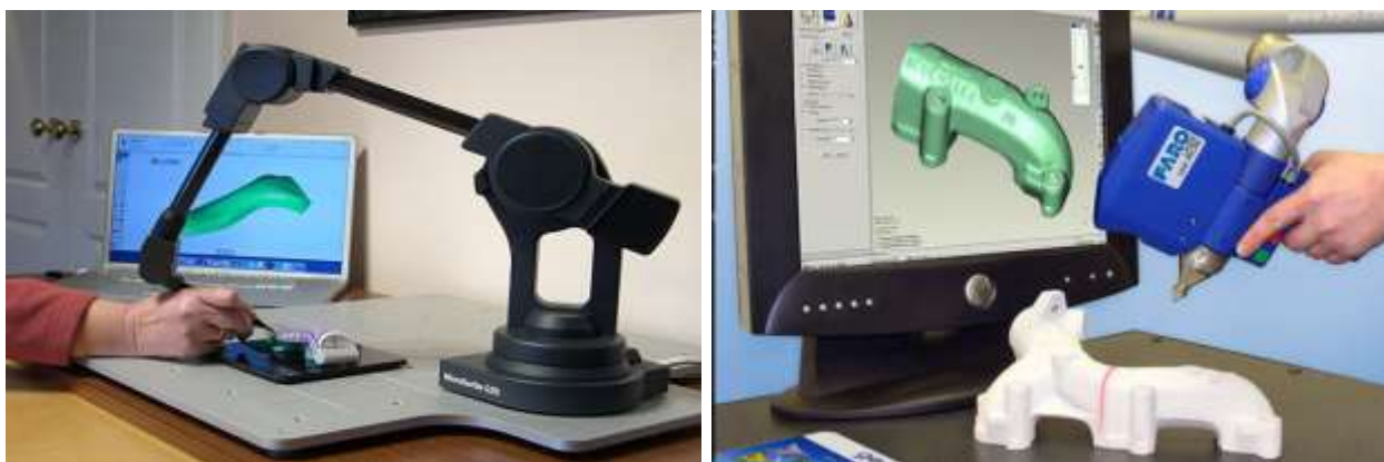
Рисунок 3 – Методы сканирования – контактный и бесконтактный
