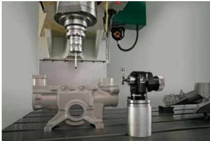
Рисунок 7 - Датчик OTS для наладки инструмента компании Renishaw
