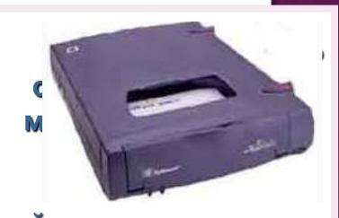
позволяет хранить на магнитной ленте информацию со всего жёсткого диска. Встроенные в стример средства аппаратного сжатия позволяют автоматически уплотнять информацию перед её записью и восстанавливать после считывания, что увеличивает объём сохраняемой информации.
