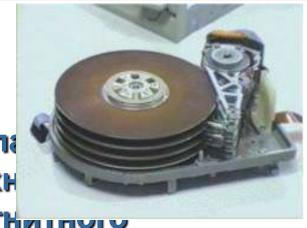
У каждой магнитной стороны пластины есть своя магнитная головка. Все головки соединены вместе и движутся радиально по отношению к пластинам. Частота вращения дисков до 7200 оборотов в мин. Скорость записи/считывания - 300 Мбайт/с. Емкость жёстких дисков достигает 500 Гбайт.
